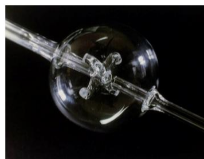
RPAC expérimental pour des systèmes gazeux (volume d'environ 50 mL) (ENSIC Nancy)
