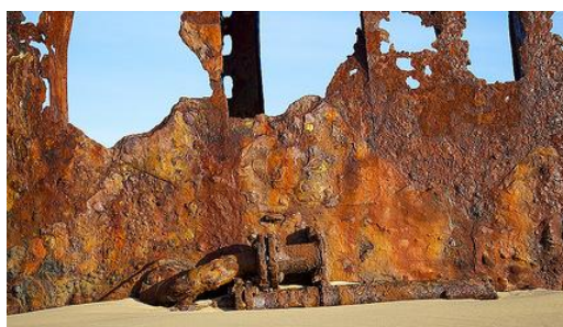
Épave de bateau : la couche de rouille ne permet pas une protection du métal en profondeur.
