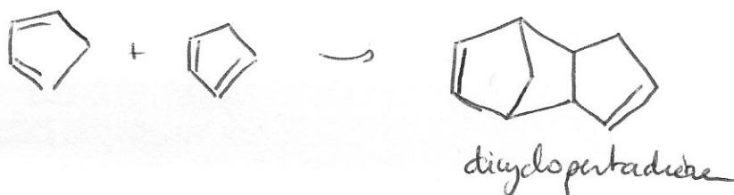
la réaction de Diels-Alder était exothermique, un chauffage permet de la réaliser en sens inverse (relation de Van't Hoff).
