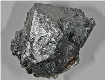
La chromite, dont la formule est  $Fe_xCr_yO_z$ , est le principal minerai du chrome. A l'état cristallin, sa structure fait apparaître un réseau cubique à faces centrées d'ions  $O^{2-}$ , avec :
