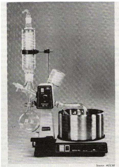
L'évaporateur rotatif est utilisé pour réaliser rapidement la concentration d'un produit par élimination du solvant. Il est utilisé sous une pression réduite modérée (10 à 100 mm de Hg), généralement produite à l'aide d'un appareil peu sensible aux vapeurs de solvant, tel que la trompe à eau.
